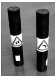
Figura 2.4.- Radiobalizas con RFID.
