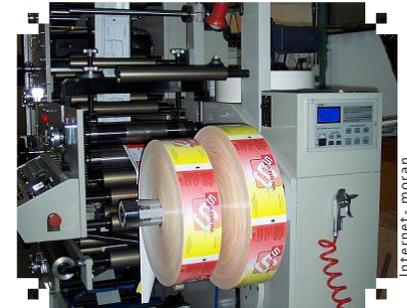
Foto 41. Flexografía. Es utilizada para la fabricación de etiquetas y envases de todo tipo.
