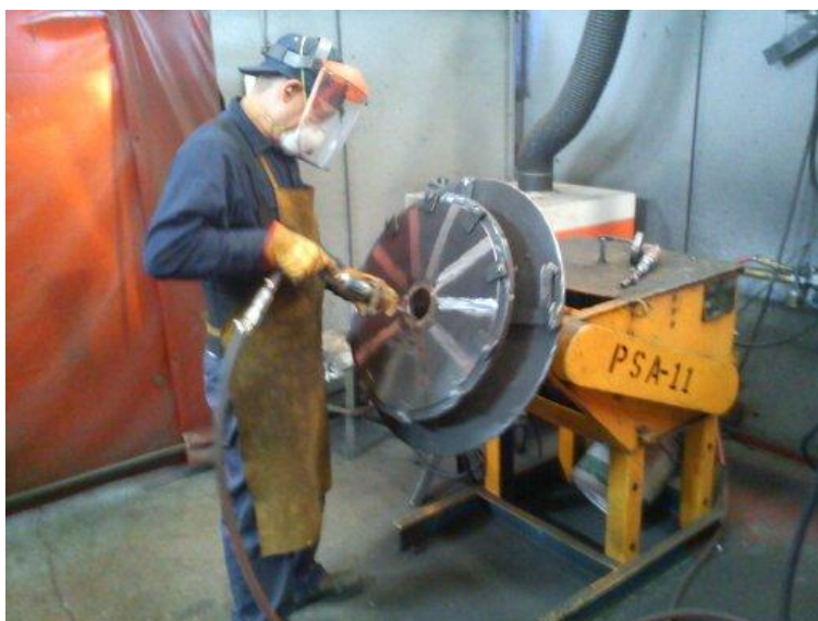
fig.20 Esmerilado de la zona del cubo con fresa.
