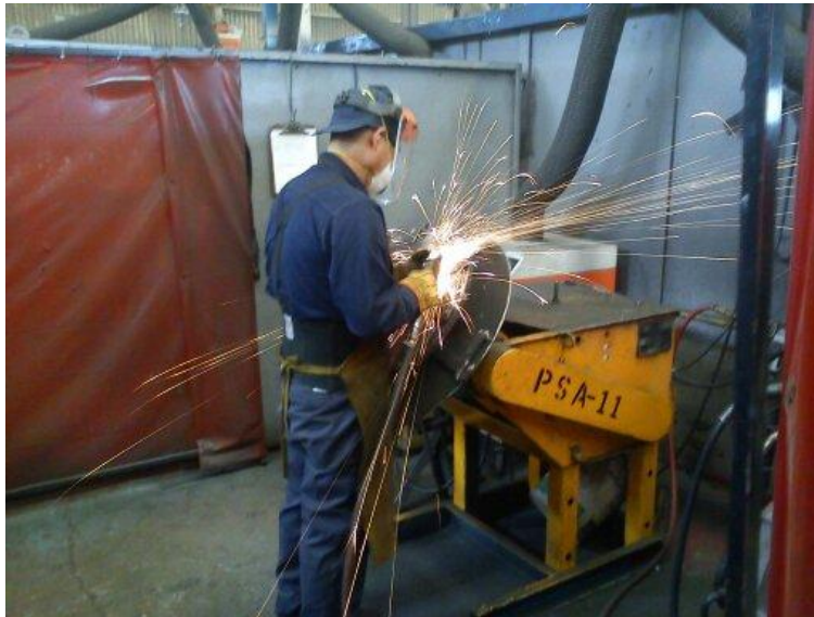
fig.17 Proceso de esmerilado del respaldo.
