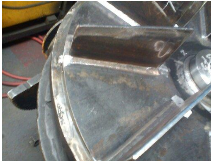
fig.25 Cordón de soldadura en las aspas.
