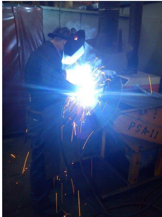
fig.21 Proceso de soldado del cubo al respaldo.
