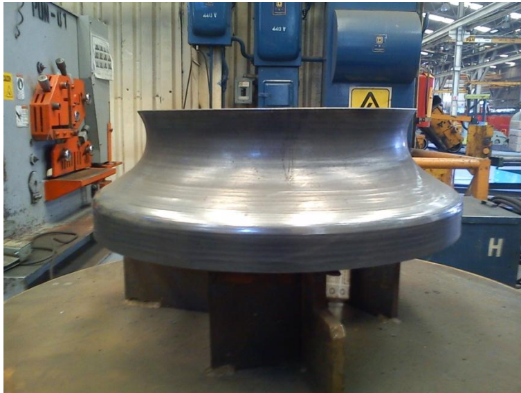
Fig.14 Tapa ya formada y cortada lista para el ensamble.
