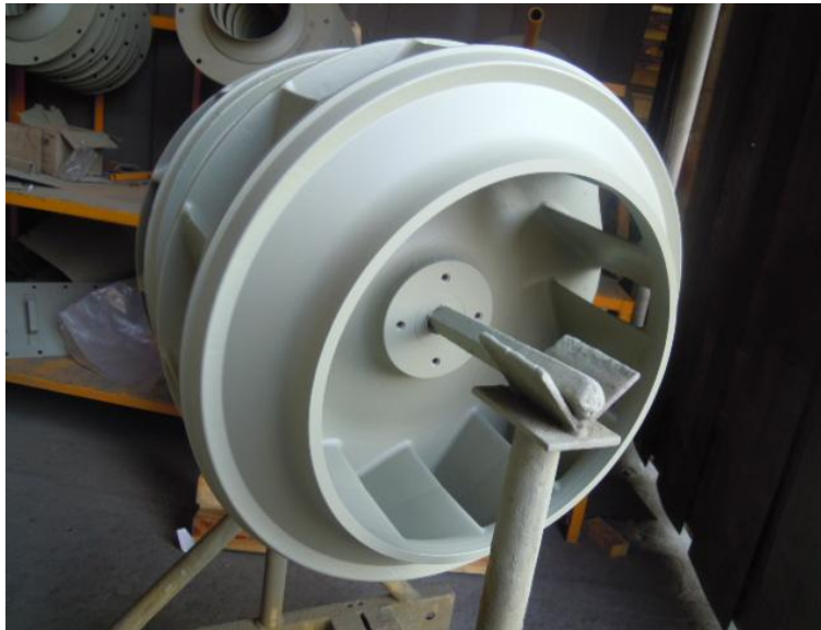
fig.30 Rueda pintada y terminada.
