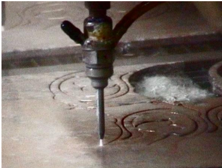
fig.32 Proceso de corte con chorro de agua.
