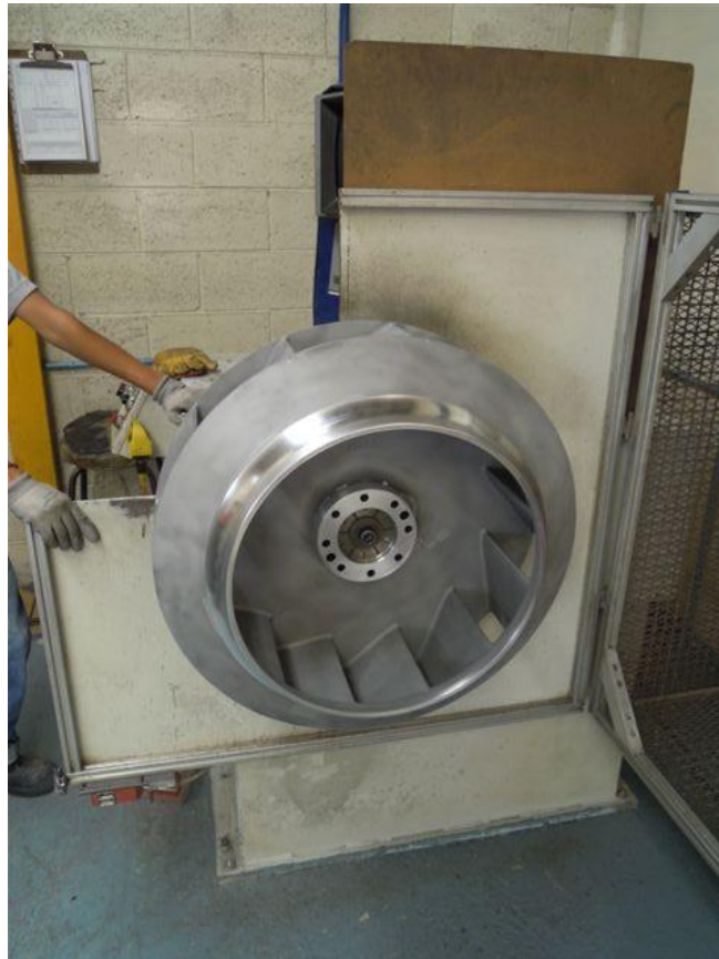
fig.28 Rueda montada en la balanceadora.
