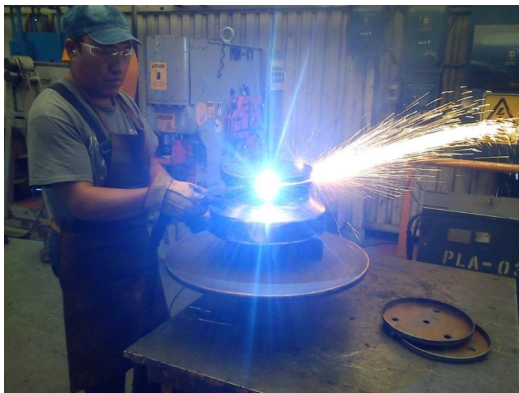
fig.13 Cortando el excedente de material.
