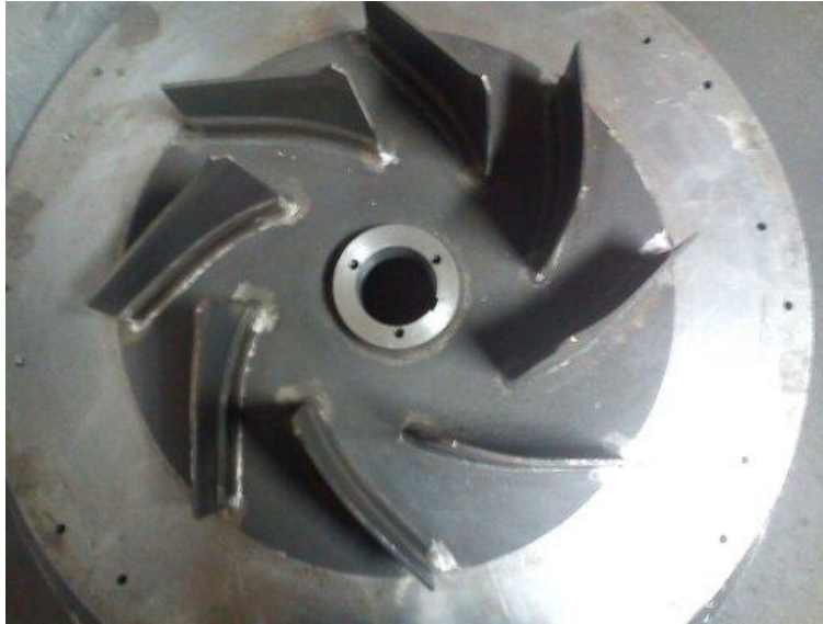
fig.24 Aspas colocadas con dos puntos en los extremos.
