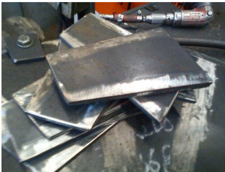
fig18. Aspas esmeriladas en zonas a soldar.
