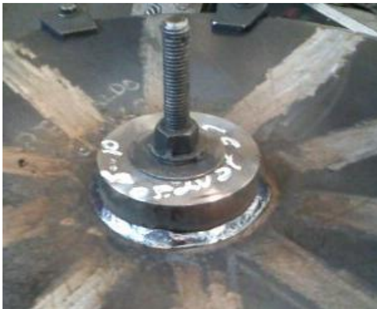
fig.23 Detalle de soldado del cubo y respaldo.
