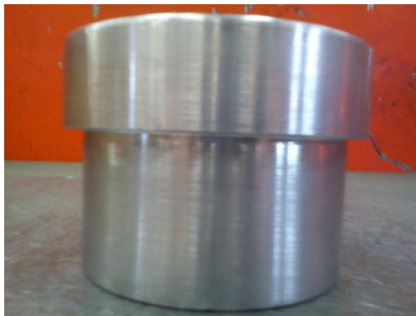
fig.15 Cubo maquinado y listo para su ensamble en la rueda.
