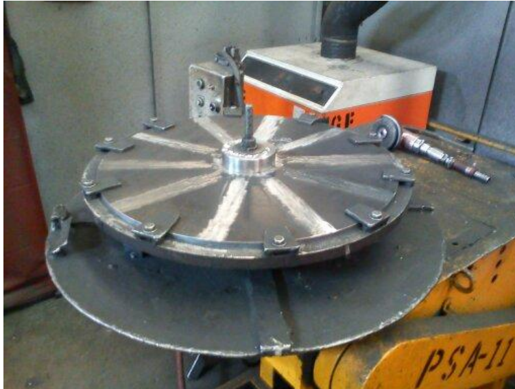
fig.22 Cubo y respaldo ya soldados.
