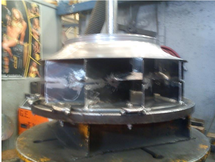
fig.27 Tapa puesta en posición lista para ser soldada.
