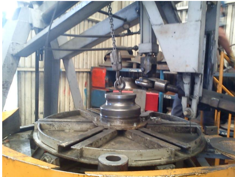
fig.12 Aro de metal siendo rechazado para la formación de la tapa.
