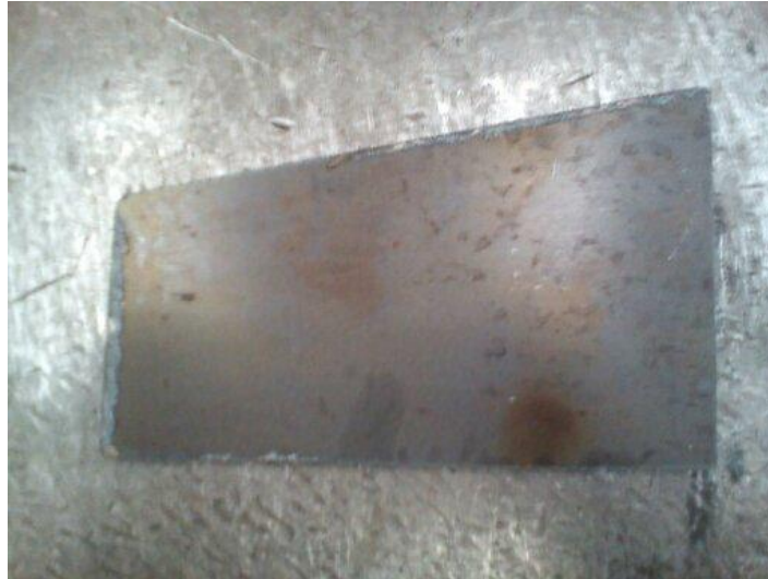
fig.11 Aspa ya cortada y lista para el preparado para el ensamble.
