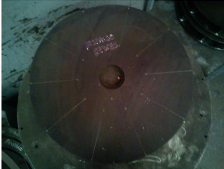
fig.10 Respaldo de una rueda ya habilitado y trazado con el lugar de las aspas.
