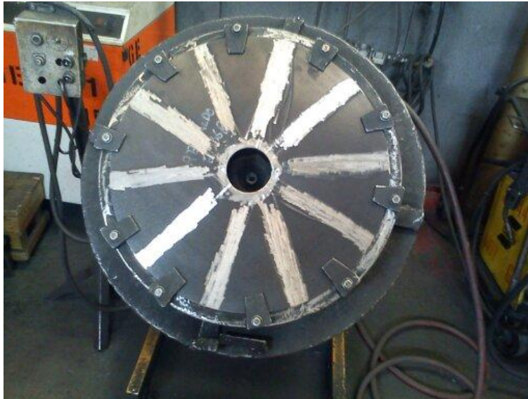
fig.19 Respaldo totalmente esmerilado.
