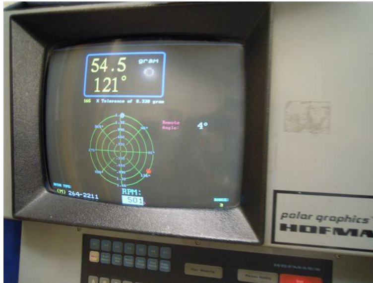
fig.29 Pantalla de la balaceadora mostrando el exceso de masa con el punto rojo.
