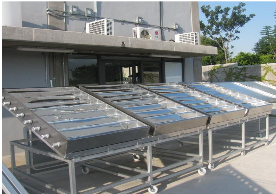
Figura 4.14. Fotografía del reactor FH-CPC-2.x fabricado en el CIE-UNAM
