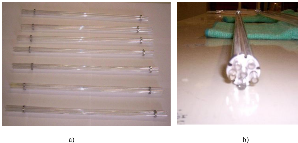
Figura 3.2. a) Arreglos de 6 tubos recubiertos de una película delgada de \text{TiO}_2 y b) soporte de aluminio para tubos recubiertos con \text{TiO}_2 .
