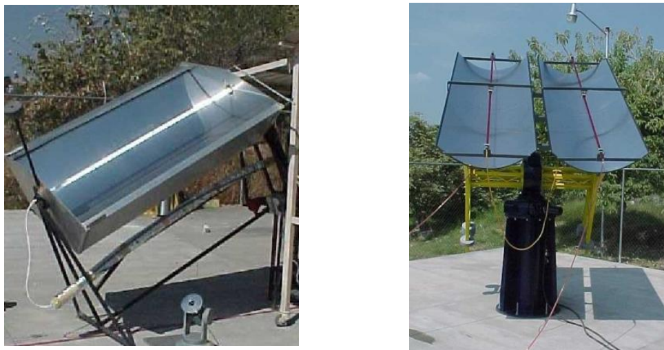
Figura 1.7. Reactores fotocatalíticos DICEF 1 y 2 construidos en el CIE-UNAM.
