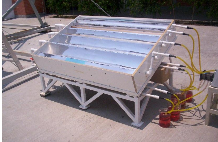
Figura 4.3. Fotografía del CPCM fabricado en el CIE-UNAM.
