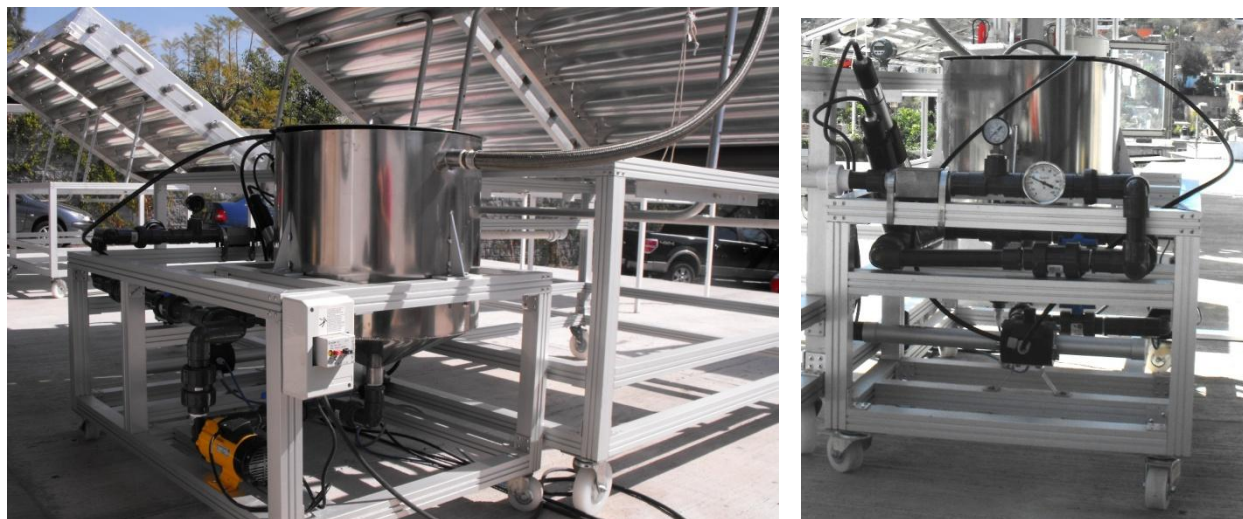
Figura 4.12. Fotografía del sistema hidráulico y de sensores del reactor FH-CPC-2x.
