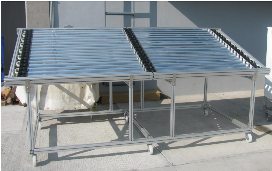
Figura 4.16. Colector solar de Ecosystem para fotocatálisis con \text{TiO}_2
