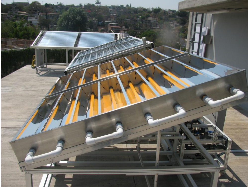
Figura 4.15. Vista lateral del reactor fotocatalítico FH-CPC-2x durante la degradación de colorantes textiles
