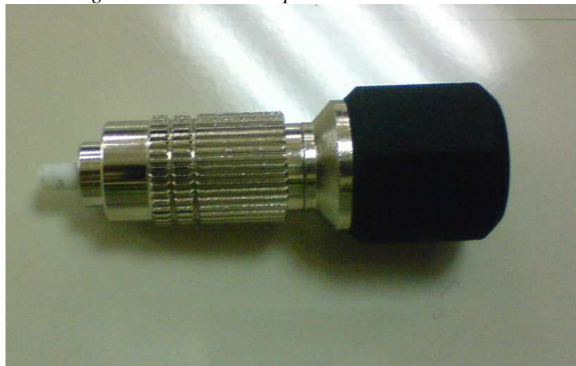
Figura 3.9. Conector temporal para fibra óptica desnuda.
