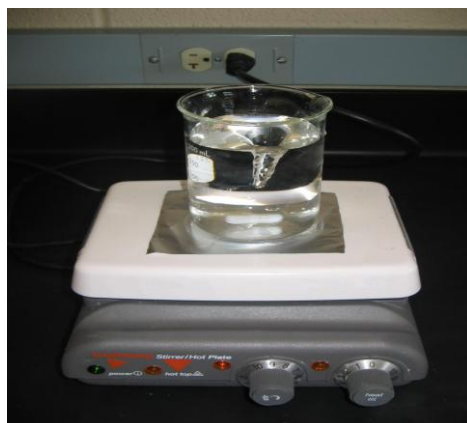
Figura 13. Parrilla de agitación magnética (Gyratherm® Magnetic stirrer-hot plate).
