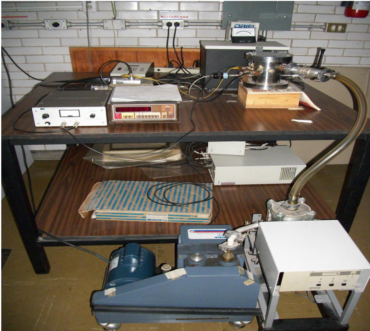
Figura 2.7. Dispositivo Experimental. Las 2 bombas de vacío, criostato, fuente de voltaje, electrómetro y monocromador.
