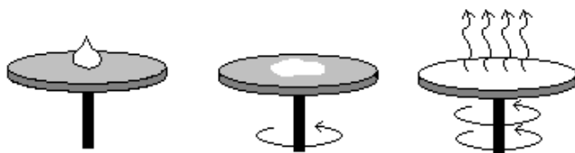
Figura 2.1 Técnica de spin-coating.
