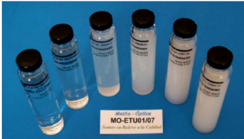
Figura 4.14 Patrones con los que se compara la turbidez del agua de muestra, para realizar la calibración del turbidímetro nefelométrico en el laboratorio de TAR, FI UNAM. Fuente: Metas & Metrólogos Asociados, Medición de la Turbidez en la Calidad del Agua.
