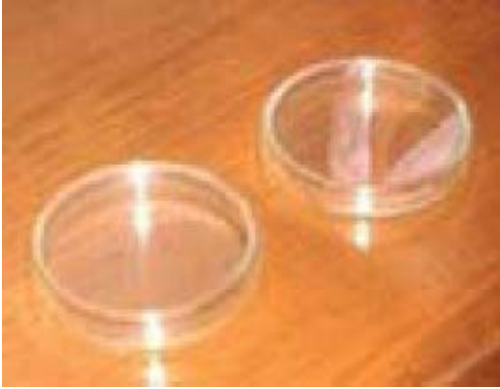
Figura 4.18 La determinación de coliformes totales o coliformes fecales dependerá del medio de cultivo utilizado en el desarrollo de la prueba, ya sea el medio ENDO o el MFC. Los coliformes son una señal del nivel de contaminación por microorganismos presentes en el cuerpo de agua, en este caso el vaso de la Presa de Valle de Bravo. Fuente: Laboratorio de Ingeniería Ambiental, FI UNAM.
