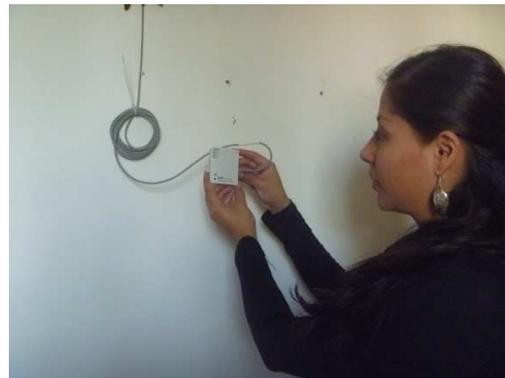
Fotografía 13 . Instalación del sensor HOBO U12, ubicado en la recámara poniente. Fuente: Archivo GARCÍA, Ilse, México 2010.
