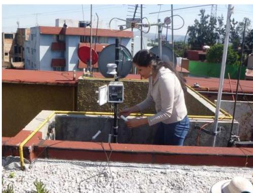
Fotografía 9 . Instalación de la estación meteorológica en la cubierta naturada. Fuente: Archivo GARCÍA, Ilse, México 2010.
