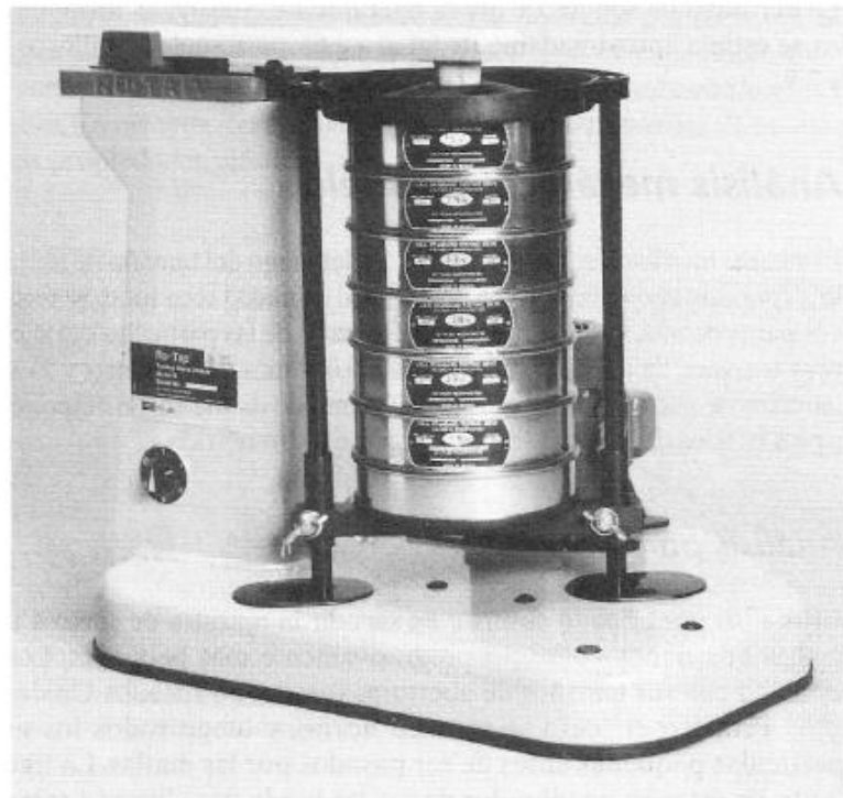
Figura 2-11. Conjunto de mallas para una prueba de laboratorio (Ref. 1)
