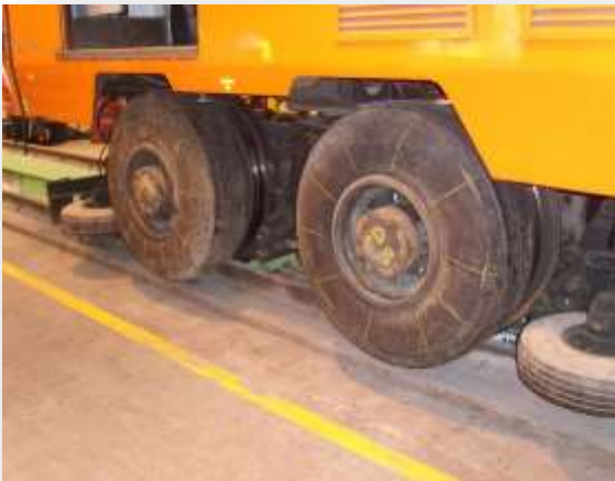
Figura. 1.14, 1.15 Metro neumático (izquierda), Metro férreo (derecha).
