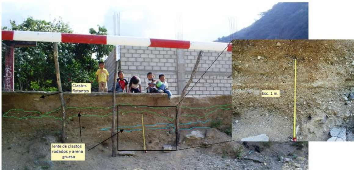
Imagen 10: Depósito masivo (Grava soportada por matriz). Las líneas verdes señalan un lente de clastos rodados, las líneas azules indican un lente de arenas gruesas.
