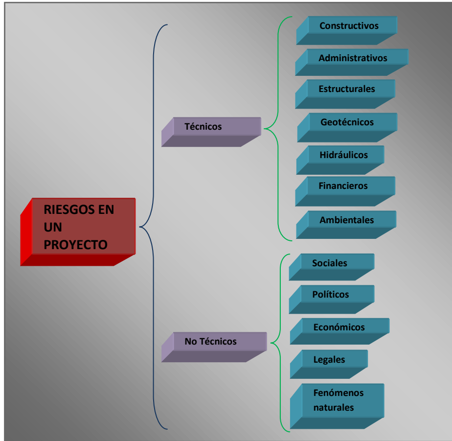
Figura 1.11 Clasificación general de Riesgos
