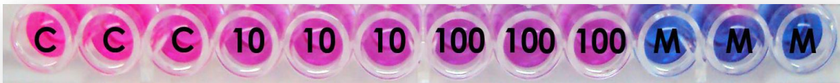
Figura 13. Validación de los controles en el microensayo de Alamar Azul (Fila H). En los pozos “C” se observa la reducción total del colorante cuya coloración es rosada. Los pozos “1:10” y “1:100” presentan reducción parcial al observarse tonalidades que varían del color lila al violeta. Los pozos “M” se observan en color azul intenso, la forma oxidada del colorante; esto implica la esterilidad adecuada del medio de cultivo empleado en las placas.
