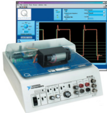
Figura IV. QNET – 010 de National Instruments, esta herramienta es un modulo multifuncional para estudiar los motores de DC
