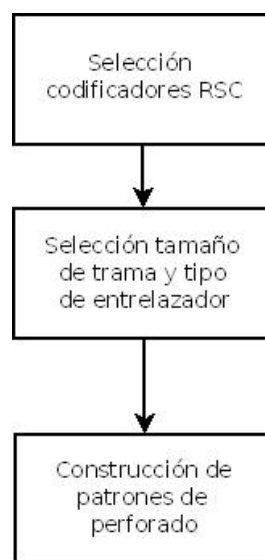
Fig. 5.1: Diagrama de flujo para la construcción de un turbo codificador considerando todos sus componentes
