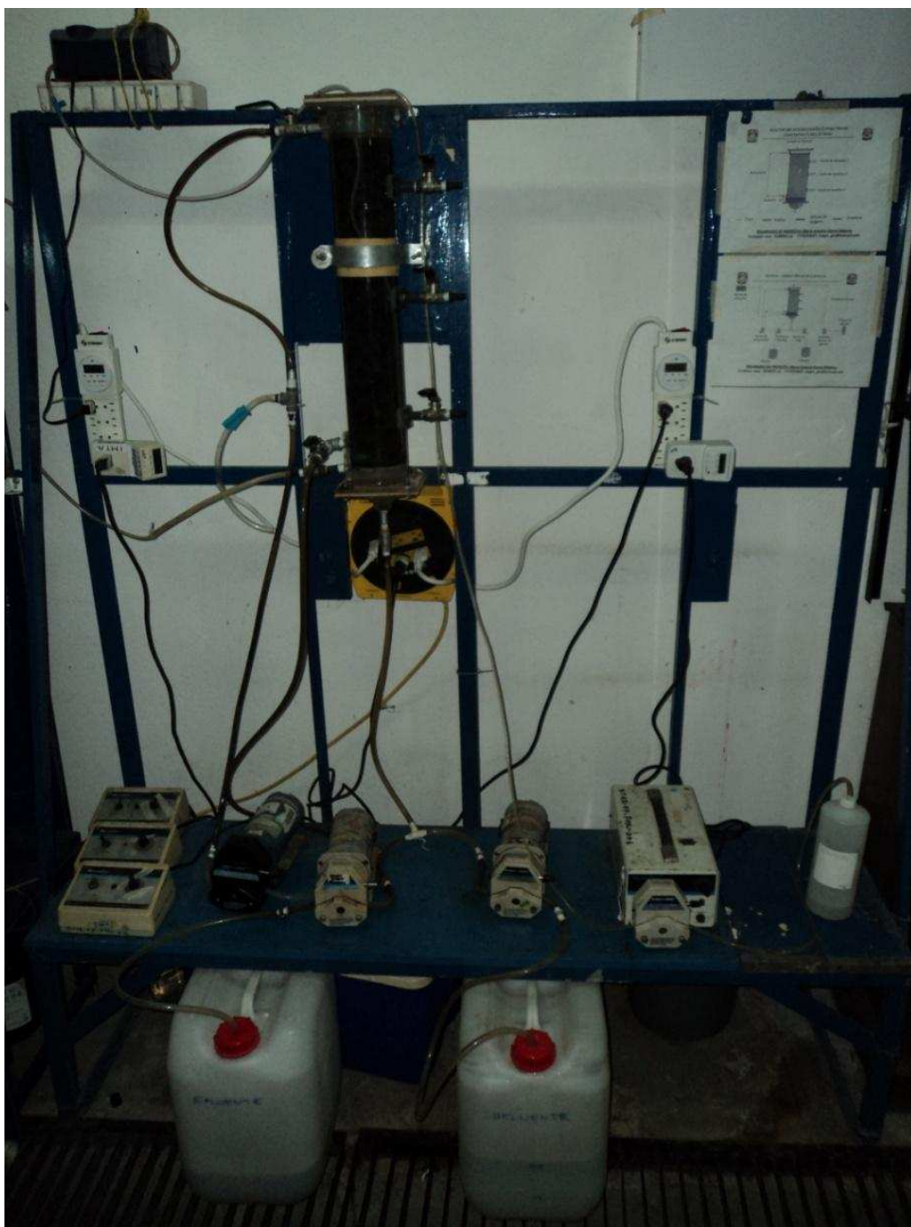
Figura 3. 1 Sistema experimental SBR aerobio/anóxico
