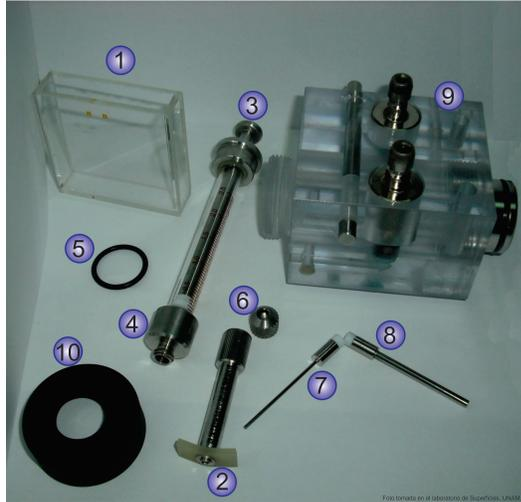
Figura 6.7: Accesorios del tensiómetro *Lauda TVT 2*.
