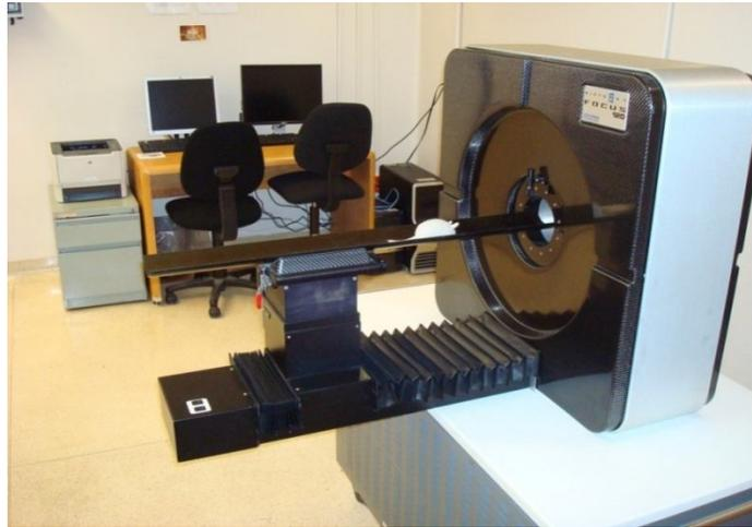
Fig. A.4. Sistema de microtomografía por emisión de positrones (microPET) Focus 120 Concorde Microsystems, Inc.
