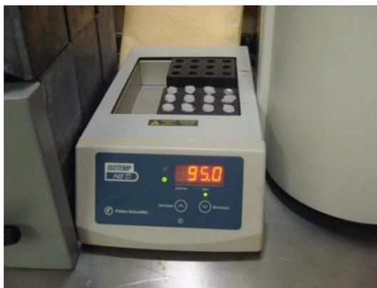
Fig. 6.7. Proceso de incubación a 95°C del complejo Ga-DOTA durante 25 min.
