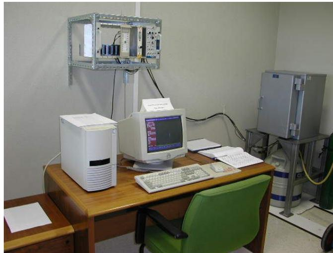
Fig. 5.2. Arreglo experimental del sistema de espectroscopia gamma [2].
