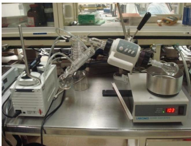
Fig. 6.5.- Dispositivo utilizado para la evaporación del HCl previamente eluido de la columna.
