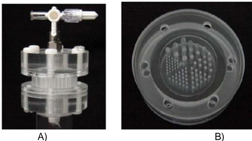
Fig. A.3. Fotografías del maniquí microDerenzo: A) vista completa y, B) vista central [4].
