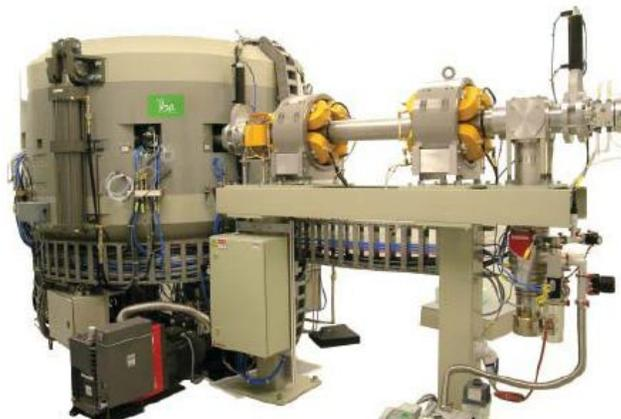
Fig. 3.1. Ciclotrón comercial (IBA Molecular) para la producción de radionúclidos de uso en PET.
