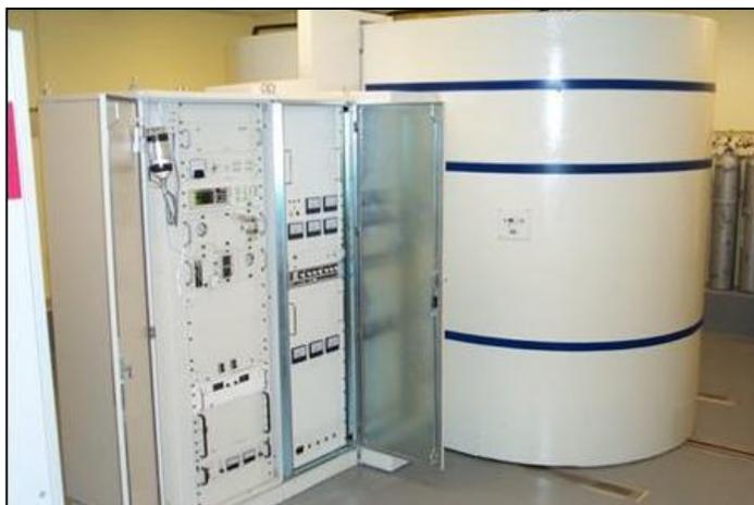
Foto 5.12. Vista exterior del ciclotrón utilizado para la producción de los emisores de positrones  $^{66}\text{Ga}$  y  $^{68}\text{Ga}$ .
