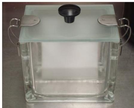
Fig. 6.9. Tanque de desarrollo con la placa cromatográfica (TLC).
