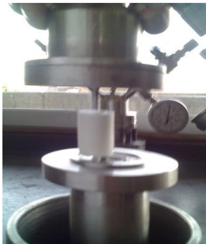
Fig. 17. Imagen que muestra el sólido que se obtiene al despresurizar el reactor.
