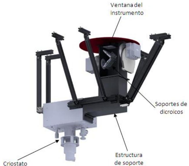
Figura 1-12: Diseño mecánico final de RATIR
