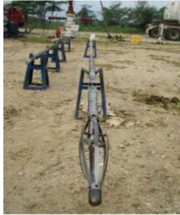
*Fig. 3.12 Medidor de caudal total, el cual tiene una helice que gira a la razon de la velocidad del fluido*
