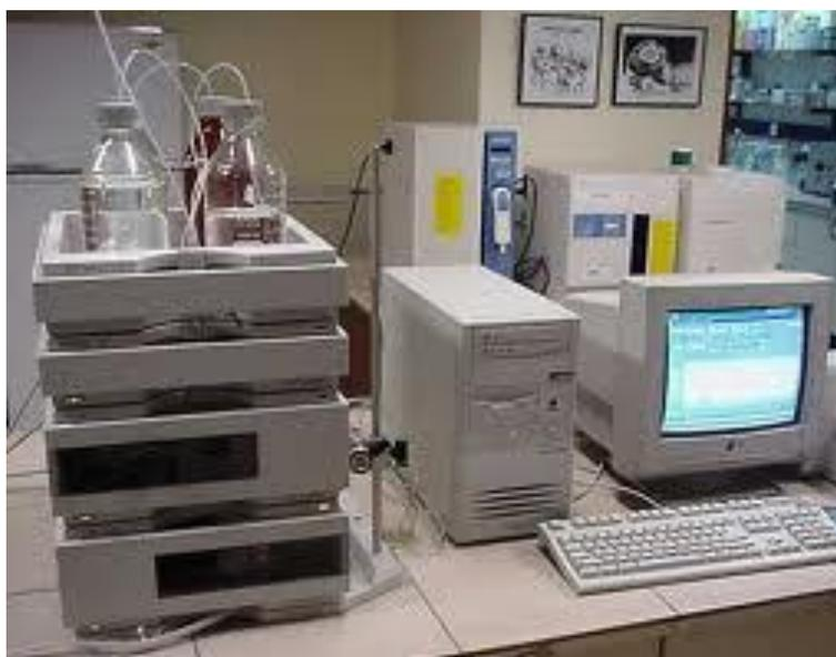
**Figura 3. Cromatógrafo de líquidos de alta resolución (modelo 1100, Hewlett Packard)**
