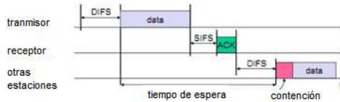
Imagen 6.5 Temporizadores DIFS , SIFS y ACK para una trama de datos
