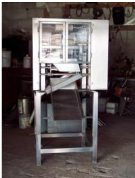
Fig. A-9. Desespinatora de alimentación vertical. Tomado de http://www.giga.com/~mag/Desespinatora.htm , fecha de consulta: 21 de Agosto de 2009.
