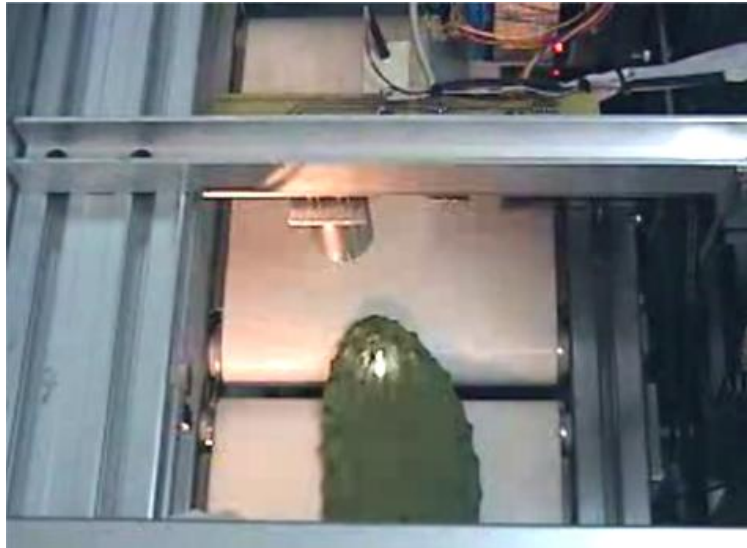
Fig. A-10.2. Las espinas son sometidas a descargas de pulsos láser. Tomado de http://www.elsiglodetorreon.com.mx/noticia/268403.desarrolla-ipn-desespina-laser-para-nopal.html , fecha de consulta: 15 de Octubre de 2009.
