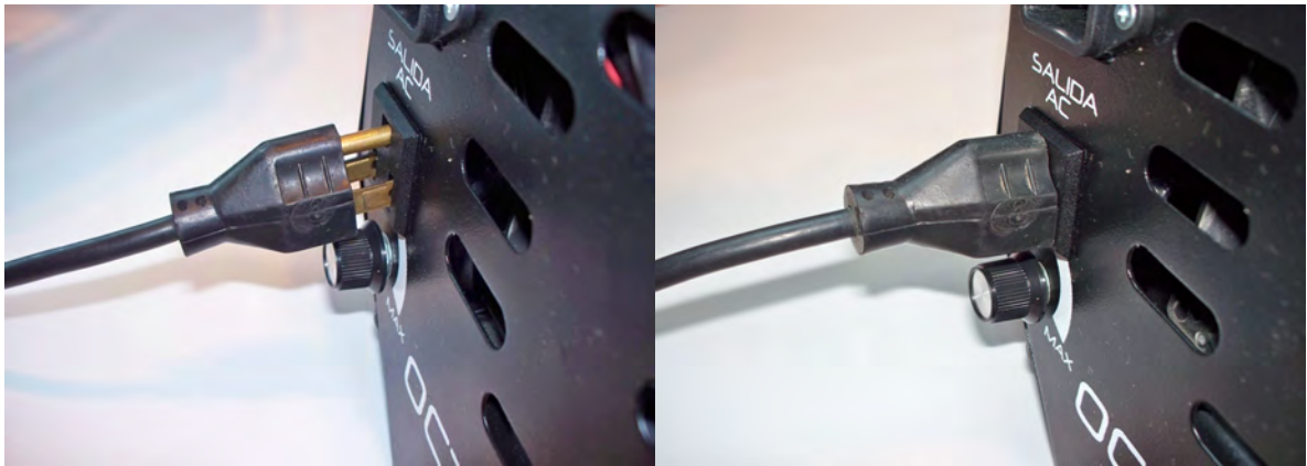
Clavija conectada incorrectamente (izquierda) y clavija conectada correctamente (derecha)
