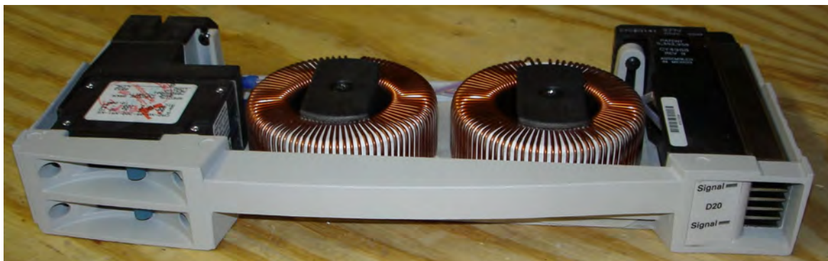
Un par de dimmers SCR con bobinas choke
