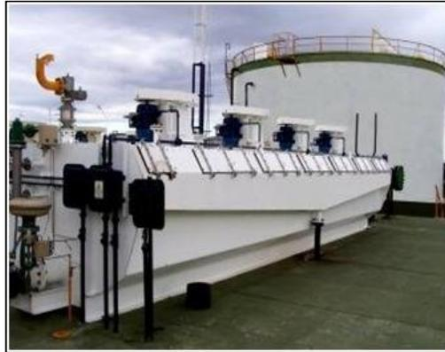
Figura 4. 7 Sistema de flotación por gas inducido (IGF)
