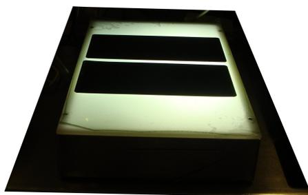
*Figura 4.2.2: Exposición de las películas MS y SR a la fuente de luz blanca.*
