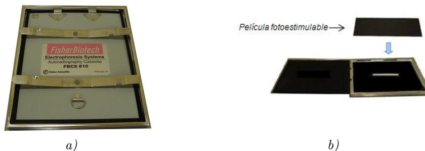
Figura 4.1.3: a) Casete de exposición mediano, b) Colocación de la muestra en el casete y exposición de la película sobre la muestra radiactiva.
