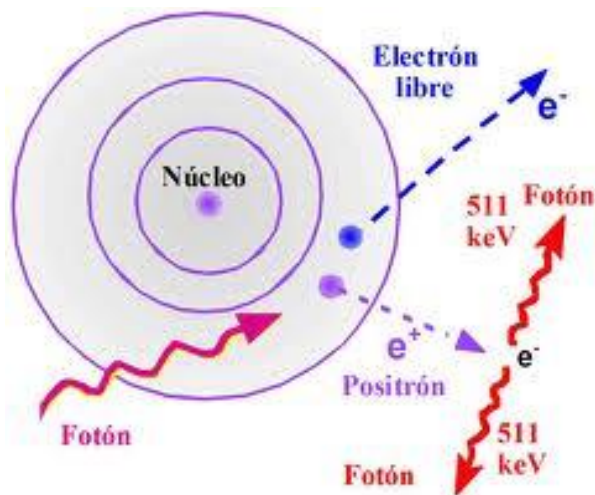
Figura 1.6. Esquema de producción y aniquilamiento de pares.
