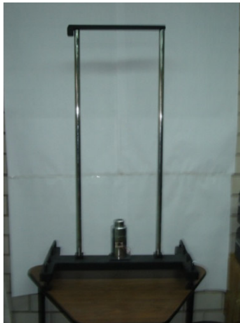
Figura 3.1. Bastidor principal, obsérvese que los postes están cromados y la base, al igual que el travesaño traen pintura anticorrosión.
