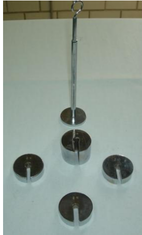
Figura 3.10. Pesas de 5 y 2 N, además del soporte de las mismas con recubrimiento en cromo.
