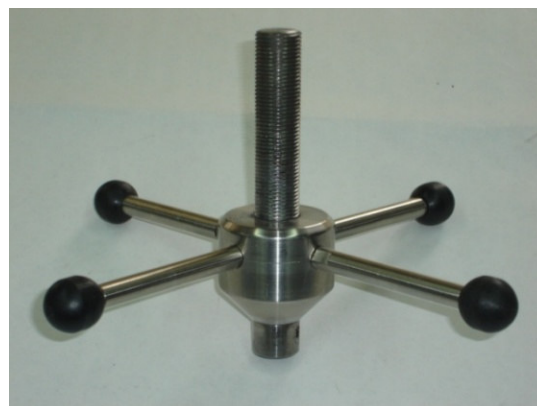
Figura 3.3. El aplicador de carga manufacturado en Acero inoxidable con todos sus elementos.
