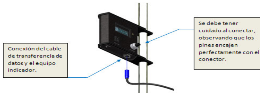
Figura 2.11. Conexión del cable de transferencia de datos con el equipo indicador.
