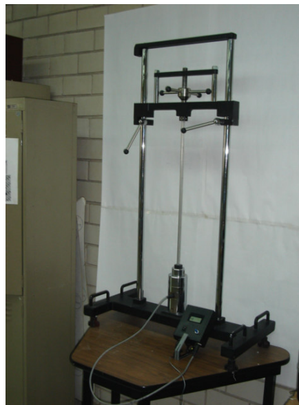
Figura 3.11. Se muestra el equipo de pandeo completamente ensamblado, junto con el equipo indicador conectado a la celda de carga.
