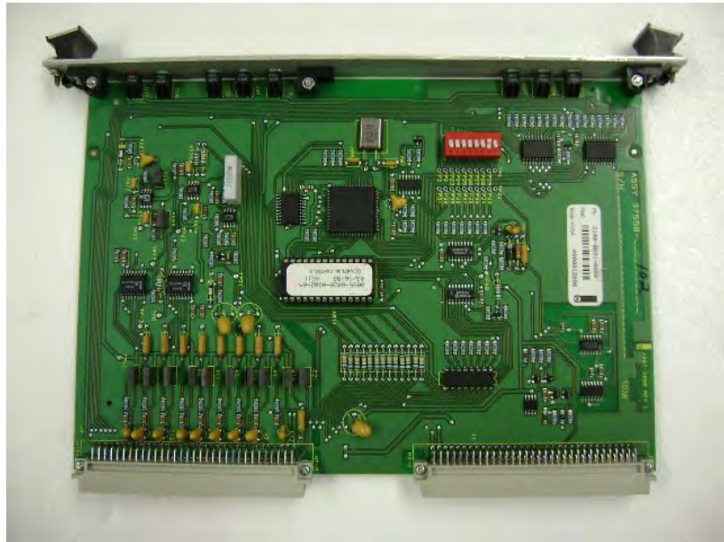
Fig.-8.22a Tarjeta que controla la temperatura interna del equipo
