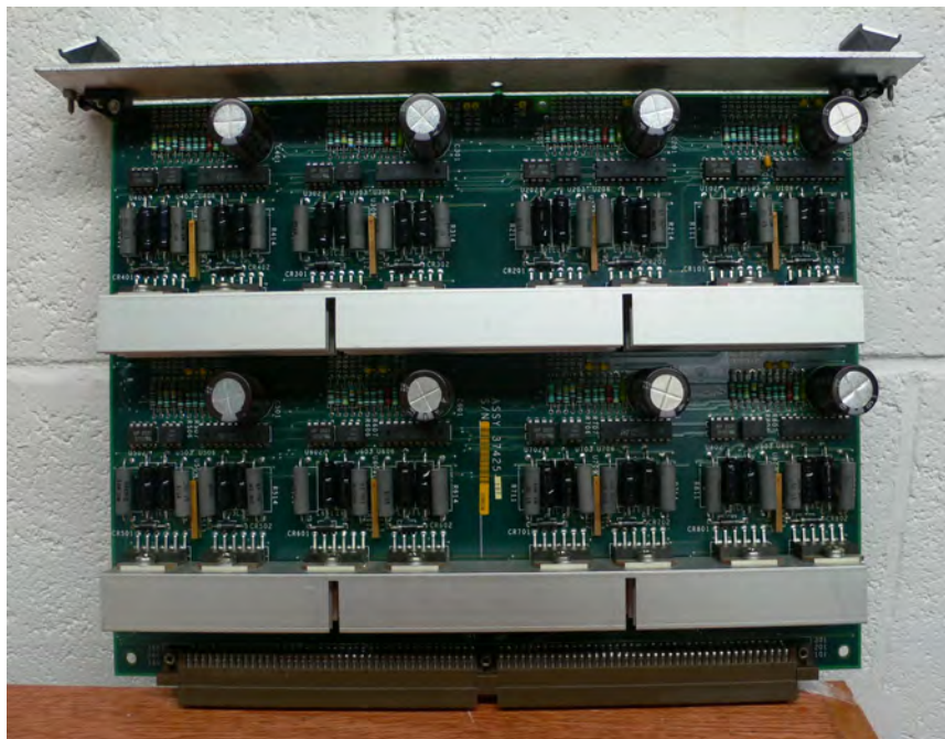
Fig.-8.15a Tarjeta que energiza todos los motores a pasos de los carruseles del instrumento.
