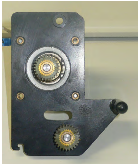
(Fig.-8.14b) Brazo del carrusel de muestras
