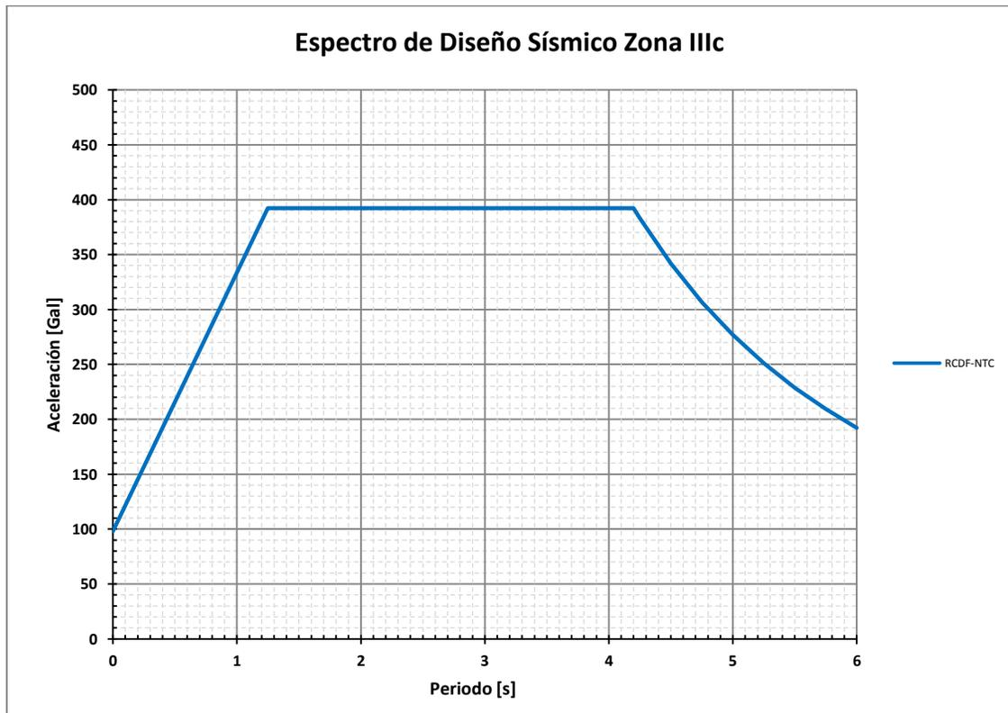
Figura V.2 Espectro de Diseño por Sismo para la zona sísmica IIIc
