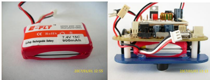
Figura 6.10 Batería empleada y su ubicación en el robot
