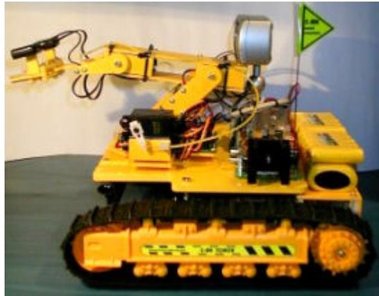
Figura 3.11 Robot con tracción de orugas
