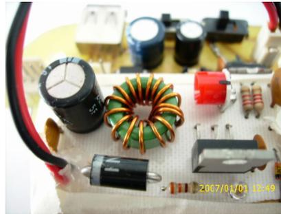
Figura 6.9 Imagen que muestra el aspecto real del circuito elevador y regulador de voltaje
