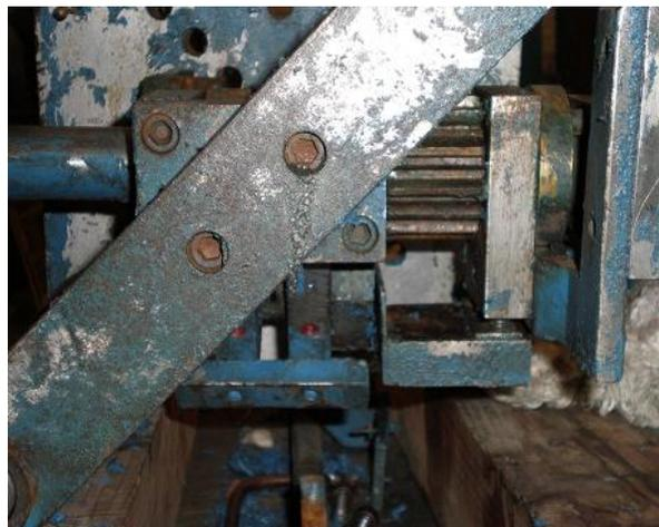
Figura 4.2.1.8 sistema mecánico de cierre
