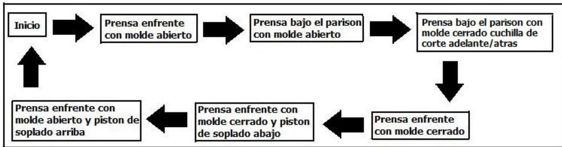
Figura 4.2.2.4.3 Diagrama de bloques del sistema de extrusión soplado
