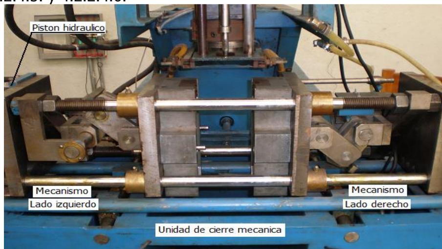
Figura 4.2.2.4.5 Mecanismo del cierre de molde de la prensa
