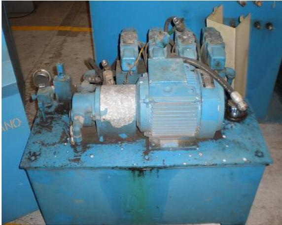
Figura 4.2.1.3 Unidad hidráulica
