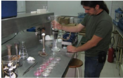
**Figura 4.11. Método de filtración con membrana**
