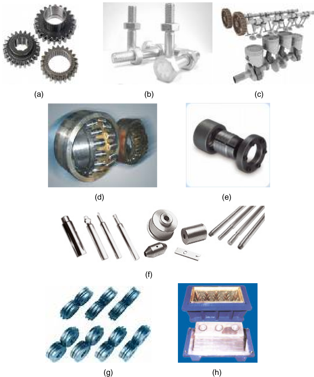
Figura 1.2 Aplicaciones de aceros borurizados en la industria: (a) engranes (acero 1015), (b) pernos (acero 1045), (c) pistones (acero 4140, H12 y H13), (d) cojinetes (acero E52100), (e) bujes (acero D2, D3, 302, 316), (f) pernos y dados para forja (acero L6), (g) rodillos (acero O2 y O7) y (h) moldes (acero 410).
