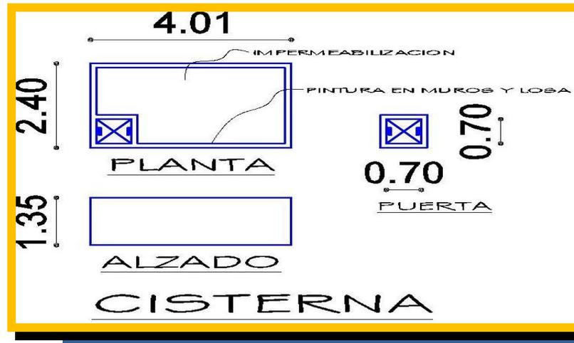
Foto 11.1.- Proyecto para la impermeabilización de tanque elevado
