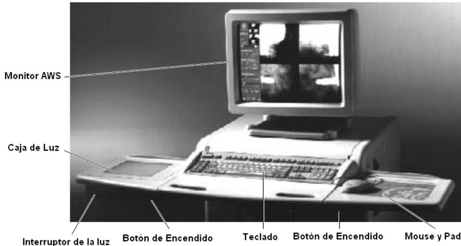
**Figura 2.3 AWS (Adquisición de Estación de Trabajo)**
