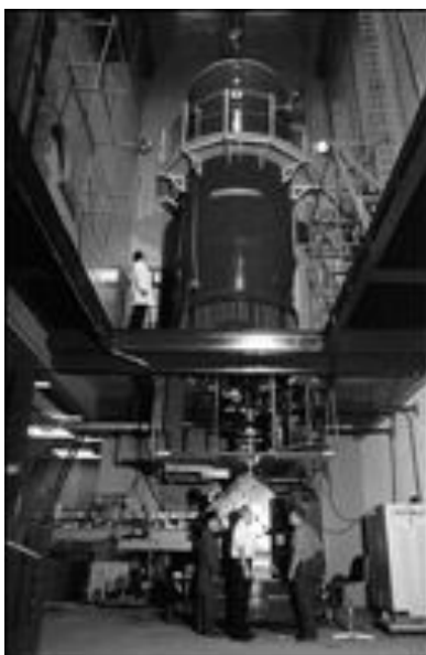
Imagen 2. Fotografía del acelerador Van de Graaff de 5.5 MV del Instituto de Física.
