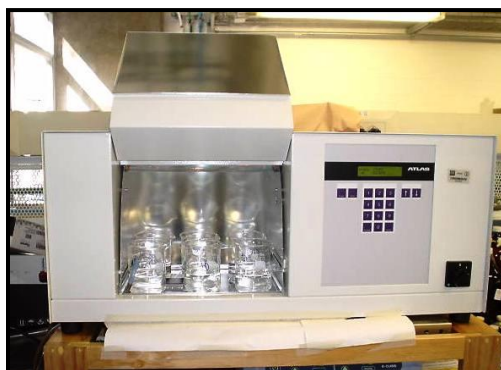
Figura 3.8 Irradiación de las muestras de agua HPLC
