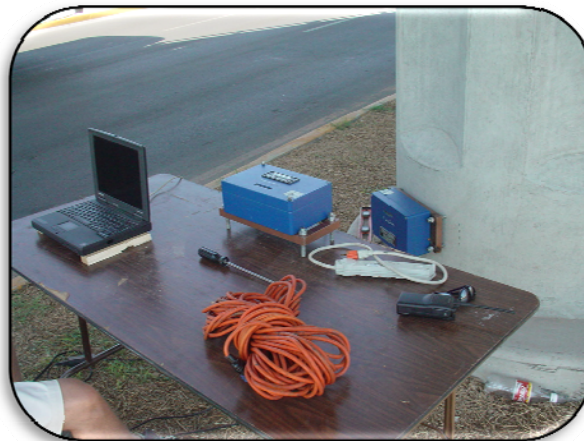
Figura 2.7 Sensores de medición de aceleraciones
