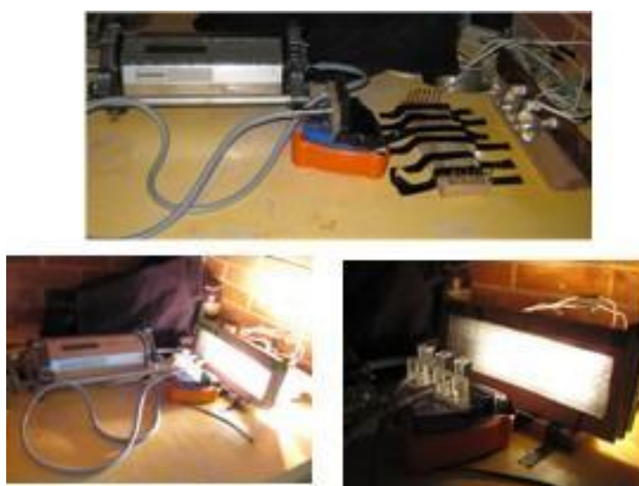
Fig. 5. El arreglo consistió en 3 celdas de plástico de 1cm de paso óptico montadas paralelamente a lo largo de una base de acrílico, para sostener la fibra óptica se pego una placa de acrílico con tres agujeros a la altura de cada celda. Este arreglo facilitó que la fibra óptica del PAM se pudiera mover de celda en celda, para hacer las mediciones.
