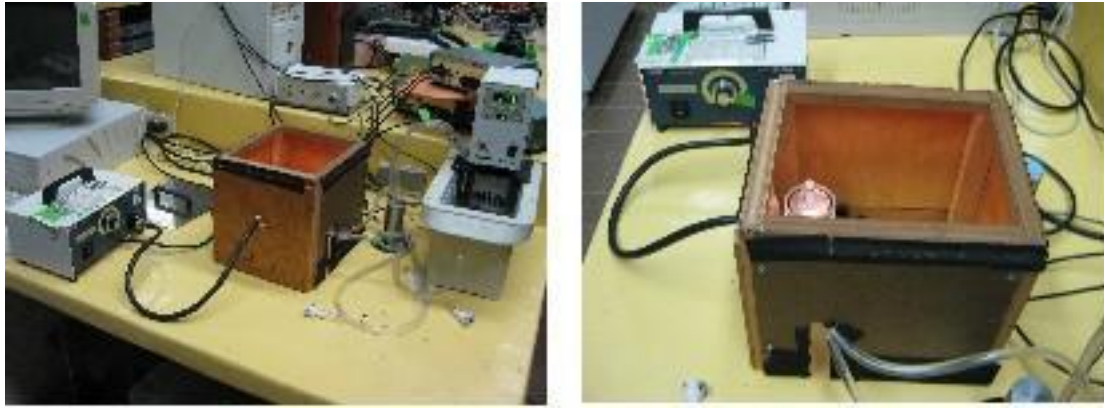
Fig. 8. Arreglo que se empleo para hacer las curvas P-E, se utilizo una caja de madera para posicionar la fibra óptica de la lámpara a la misma altura de la cámara de medición.
