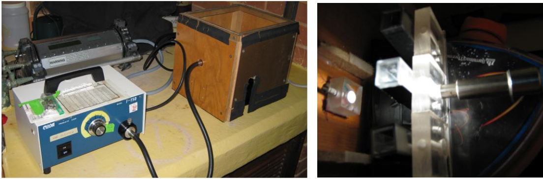
Fig. 6. Como en el primer arreglo, este consistía en una cubeta de 1 cm de paso óptico montada sobre la base de acrílico, se colocó otra placa de acrílico perpendicularmente con un hoyo con el fin de sostener la fibra del fluorómetro, del mismo modo se monto sobre un agitador magnético, y se le agregó 2 ml de muestra de S. kawagutii a una concentración de 3.5 \times 10^6 cels/ml. Para determinar la máxima eficiencia fotoquímica (Fv/Fm) se oscureció la muestra durante 5min y se iluminó con pulso de luz saturante.
