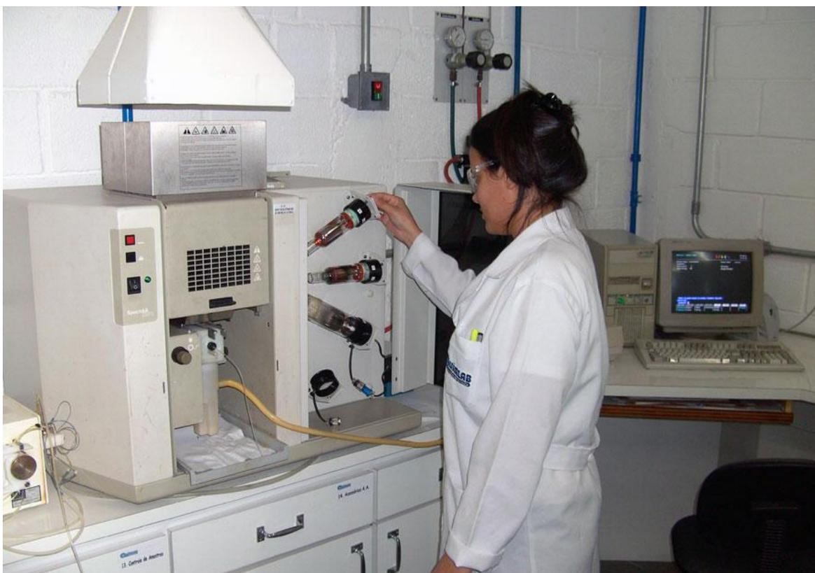
Figura 6. Espectrofotometría de absorción atómica. La mediciones de plomo en sangre se realizaron en la FES áCuautitlán.
