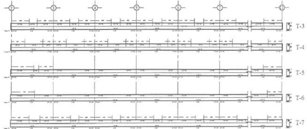
Armado de Traves Marco Longitudinal. Torre de Habitaciones
