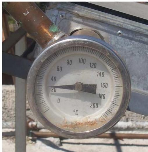
Ilustración 37 TERMÓMETRO DE VARILLA
