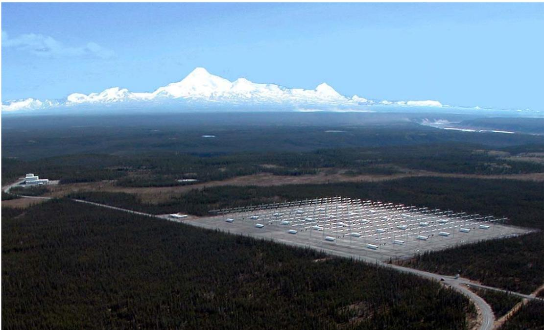
Vista aérea de las 180 antenas que componen el Ionosferic Research Instrument (IRI).
