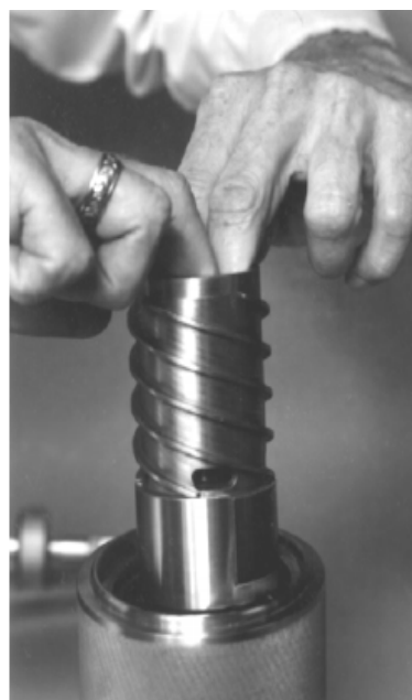
Instalación del rotor en la celda
