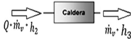
**Figura 3.3 Esquema de una Caldera Mostrando los Flujos de Energía.**
