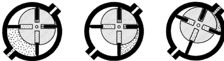
**Figura 5.24 Funcionamiento del Compresor de Paletas Deslizables.**
