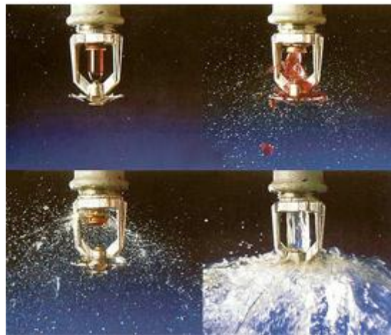
Fig. 3.1 Secuencia fotográfica del funcionamiento de un rociador automático de ampolla típico
