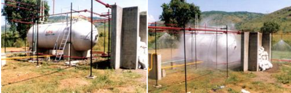
Fig. 3.15 Prueba de un sistema de aspersores para la protección de un recipiente a presión
