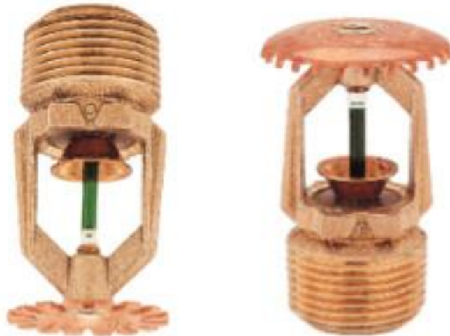
Fig. 3.7 Rociadores del mismo modelo para la instalación colgante y montante. Nótese la diferente forma de los deflectores
