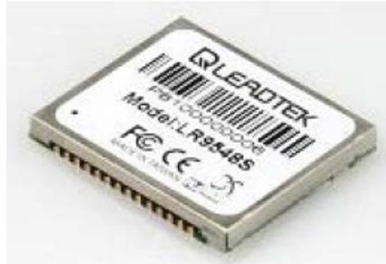
Figura 3.6 Módulo GPS GPS9548SLP de la compañía Leadtek.
