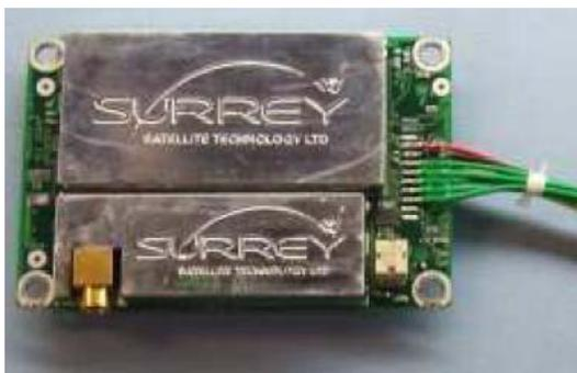
Figura 3.8 Receptor GPS SGR-05 con calificación espacial.
