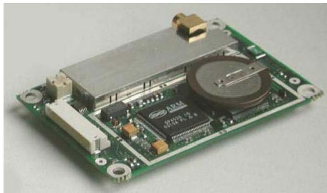
Figura 3.7 Receptor GPS Phoenix con calificación espacial.
